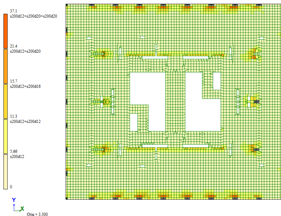
Рисунок. Требуемое верхнее армирование по Y.
